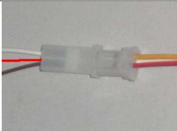
... nehmen Sie das andere Ende des Verteilerkabels mit dem weiblichen Stecker. Dieses wird mit dem Kabel aus der Lichtmaschine verbunden.
