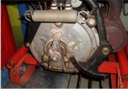
**- Hinweis zum Schalter****- Vorteile gegenüber dem alten System:****Lichtmaschine/elektronische Zündung für Stationärmotor ZW1103 in der DDR Löschpumpe TS8**
