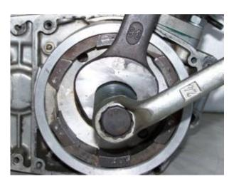
Als nächstes ziehen Sie den Rotor mit einem Abzieher (vermutlich M36x1,5 -Nicht im Lieferumfang!-) von der Kurbelwelle.
