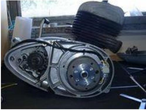
**Lichtmaschine mit elektronischer Zündung für Pannonia P20/P21 (2 Zylinder)**
