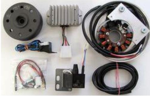
**Vorteile gegenüber dem alten System:****Lichtmaschine/elektronische Zündung für Triumph BDG250 und Triumph Boss**
