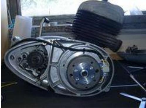
**Lichtmaschine/elektronische Zündung für Motor ILO M2x125 (2 Zylinder)**
