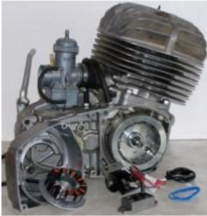
**Lichtmaschine/elektronische Zündung für CZ 981 (380ccm)**
