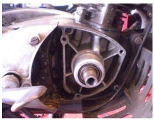
Die weiteren Arbeiten erfolgen nicht am Motorblock selbst, sondern dem Teller (der als Träger der Lichtmaschine dienenden hinteren Abdeckung)
