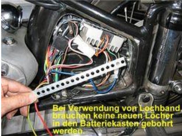
Bei Verwendung von Lochband, brauchen keine neuen Löcher in den Batteriekasten gebohrt werden
