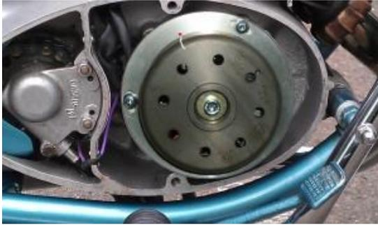
**Lichtmaschine/elektronische Zündung für Adler M/MB 200/250 und Favorit / Sprinter / Cross**
